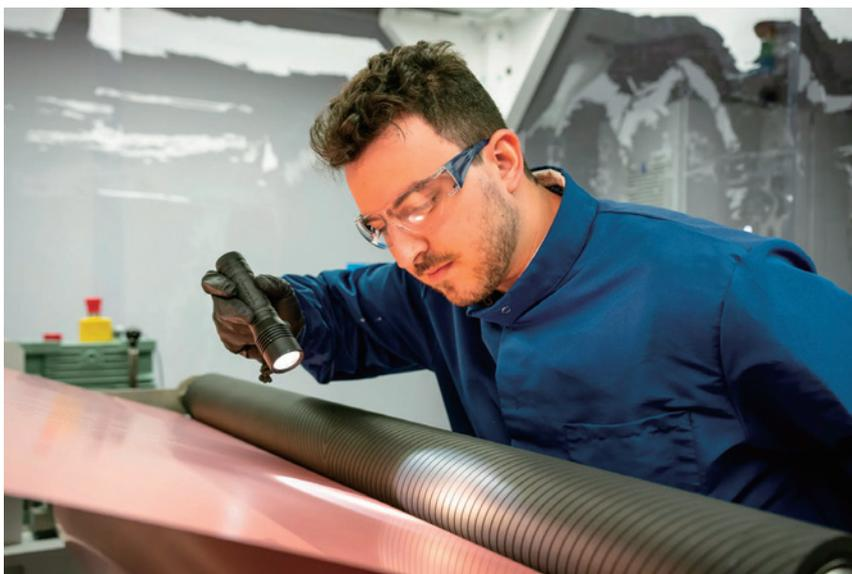
レッドウッド・マテリアルズの製品の1つは、リチウム電池のアノードに使用される銅箔だ。写真は、技術者が製造ラインから運び出される製品を検査しているところ。
